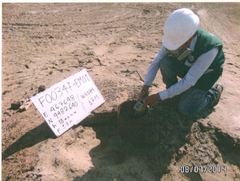
Fotografía N° 4. Medición en el punto F00347-EM01, ubicado en la fuente de emisión en boca del Pozo T_324.
