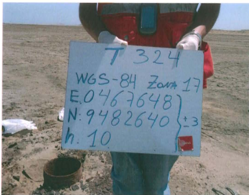
Fotografía N° 1. Identificación del pozo inactivo con código PERUPETRO T_324. Presenta casing sin válvulas que aseguren su hermetismo.
