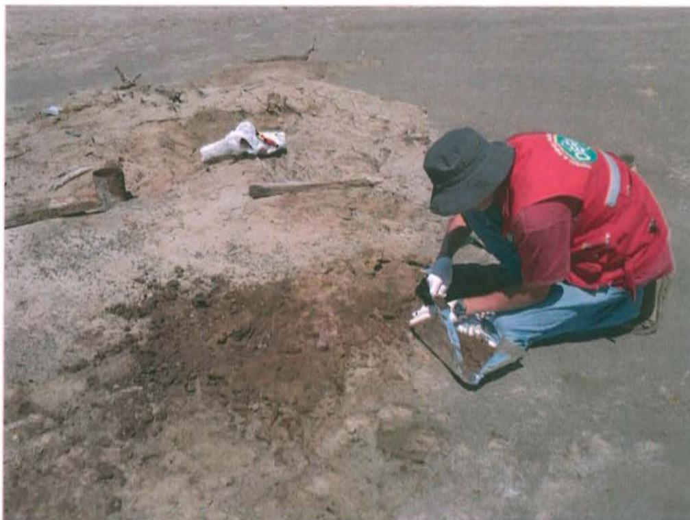
Fotografía N° 3. Toma de muestra de suelo en el punto T 353 S1, ubicado aproximadamente a 4 m al oeste del Pozo T\_353.
