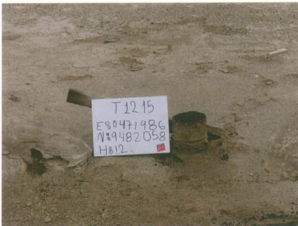
Fotografía N° 1. Identificación del pozo inactivo con código PERUPETRO T1215. Presenta casing sin válvulas que aseguren su hermetismo.
