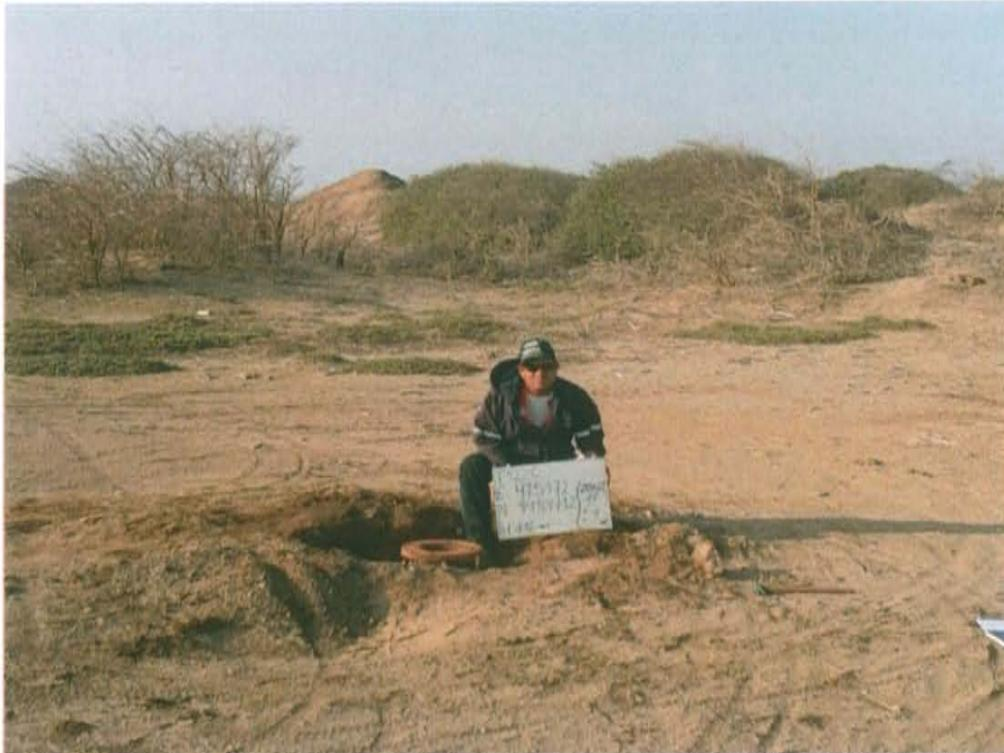
Fotografía N° 1. Identificación del pozo inactivo con código PERUPETRO T1712. Presenta casing sin válvulas que aseguren su hermetismo.
