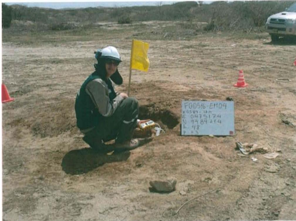
Fotografía N° 4. Medición de emisiones gaseosas fugitivas en el punto F00516-EM04, ubicado en la fuente de emisión en boca del Pozo T1712.
