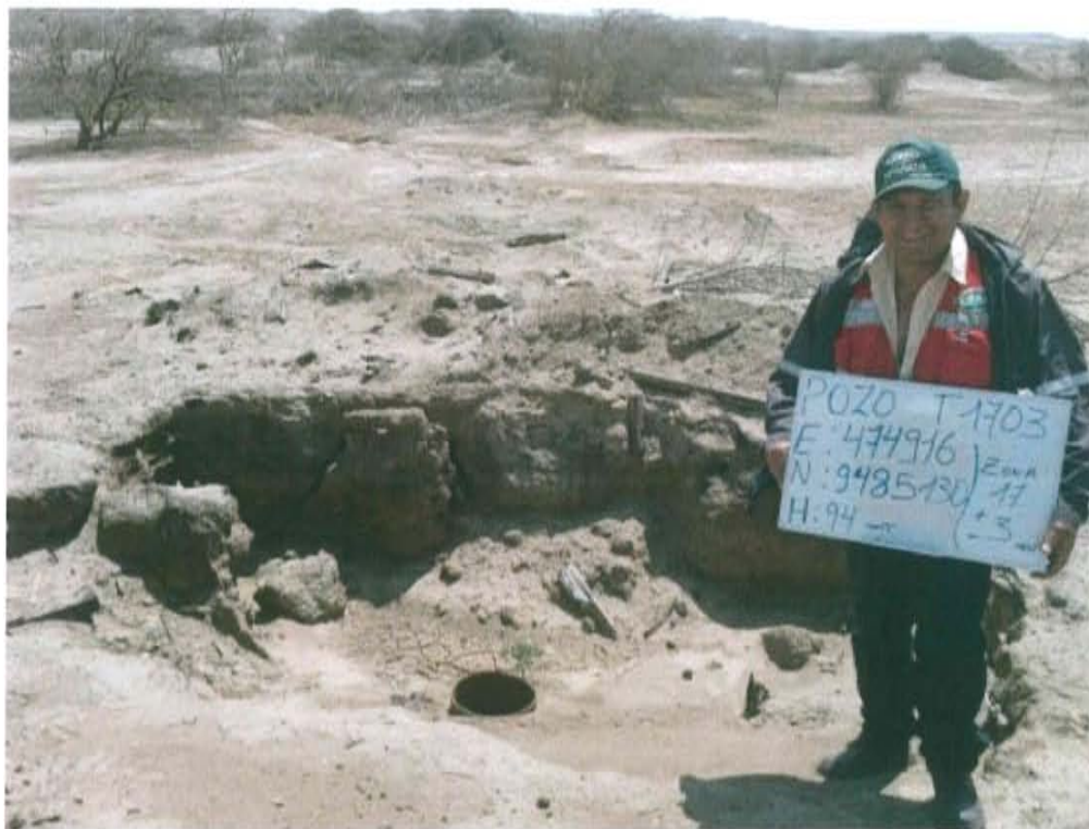
Fotografía N° 1. Identificación del pozo inactivo con código PERUPETRO T1703. Presenta casing sin válvulas que aseguren su hermetismo.
