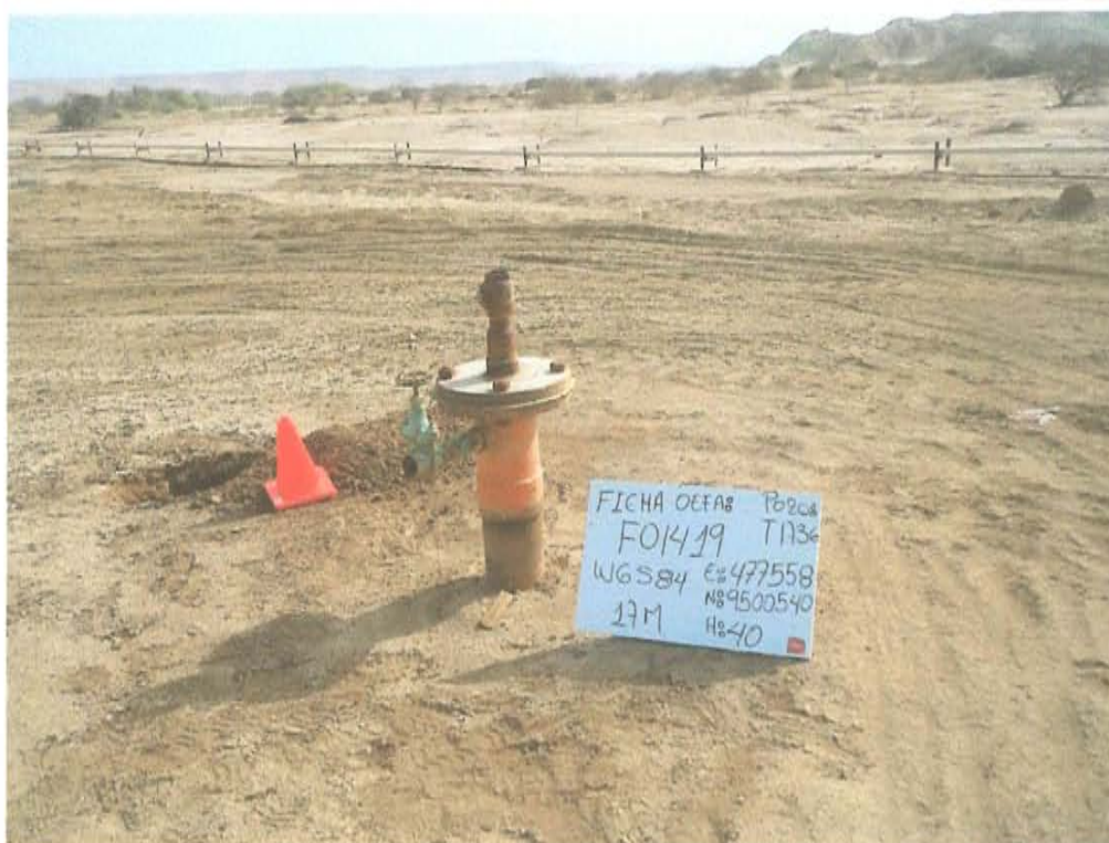
Fotografía N° 1. Pozo inactivo, se observa cabezal con brida y válvula de bloqueo y bola.
