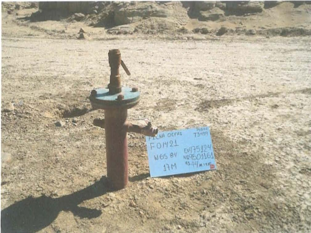
Fotografía N° 1. Pozo inactivo, se observa cabezal del pozo con válvula de bloqueo se encuentra cerrado.
