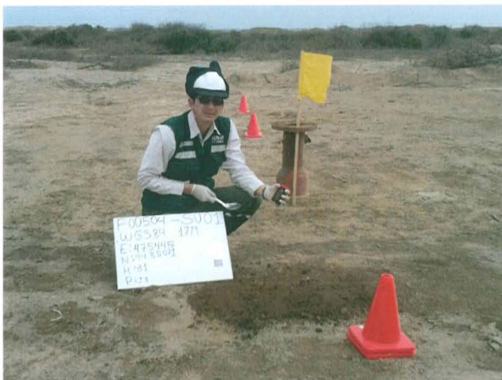
Fotografía N° 3. Toma de muestra de suelo en el punto F00504-SU01, ubicado aproximadamente a 2 m del Pozo T1678.
