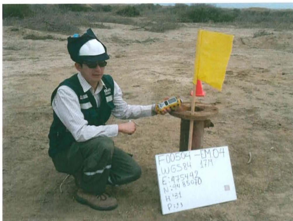
Fotografía N° 4. Medición de emisiones gaseosas fugitivas en el punto F00504-EM04, ubicado en la fuente de emisión en boca del Pozo T1678.
