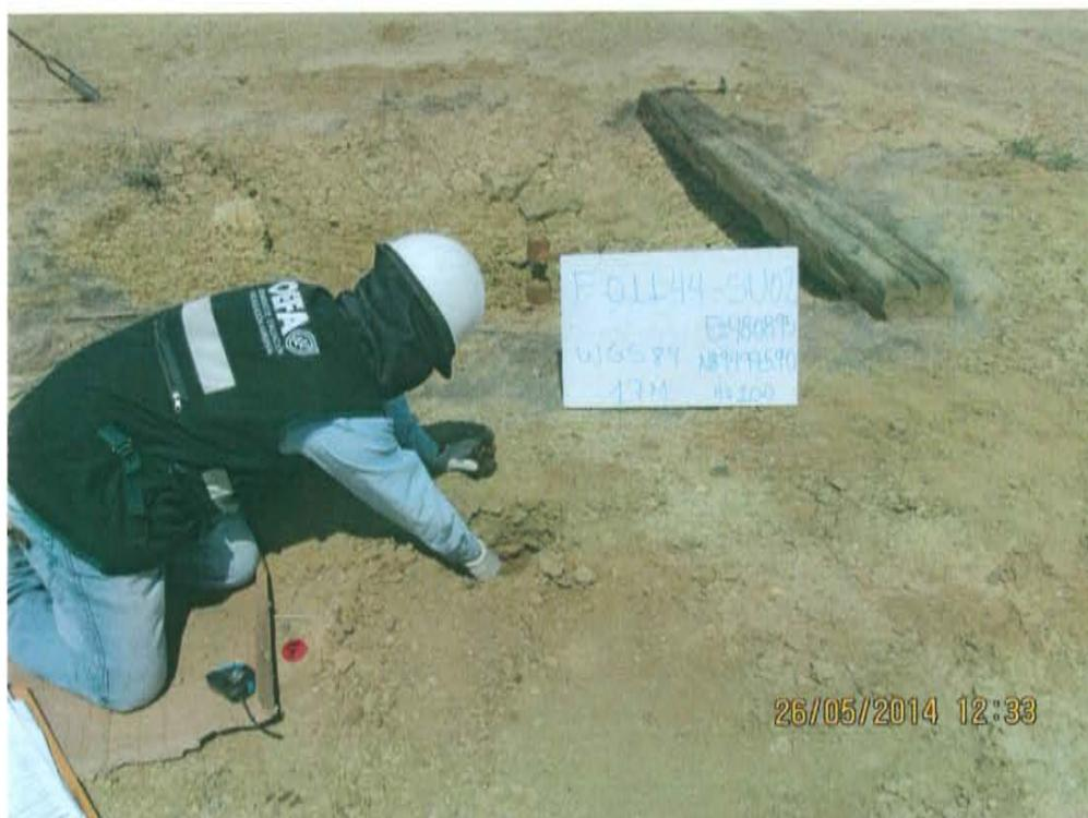
Fotografía N° 4. Toma de muestra de suelo en el punto F01144-SU01, ubicado a 2,4 m aproximadamente al norte del Pozo T 5531.
