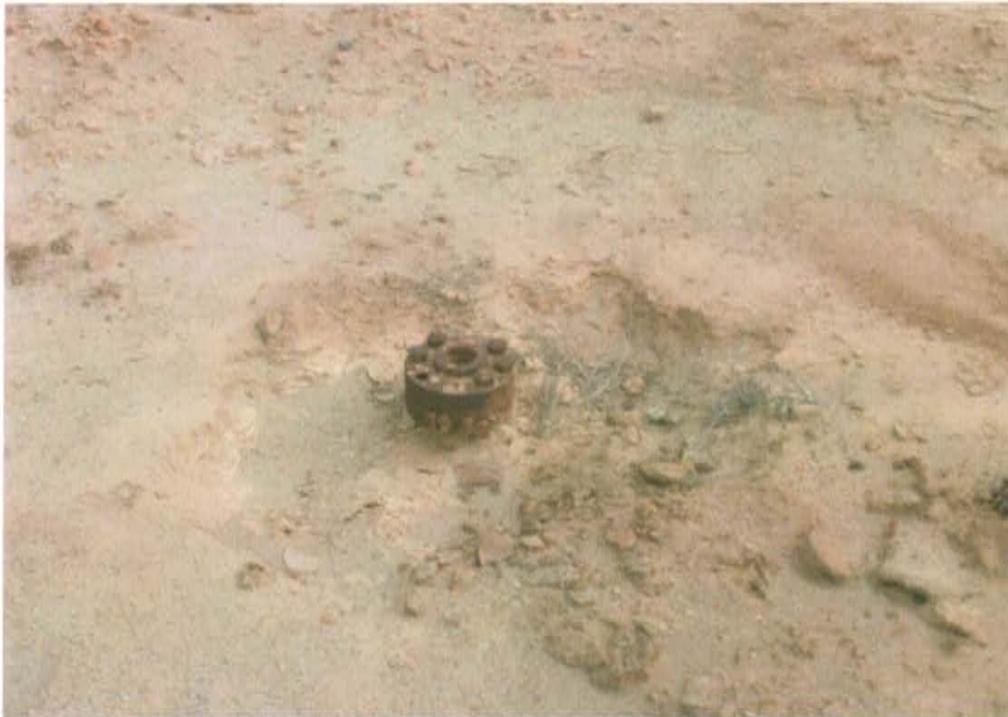
Fotografía N° 1. Pozo L 1938, con casing corroído con brida y válvula de desfogue enterrada
