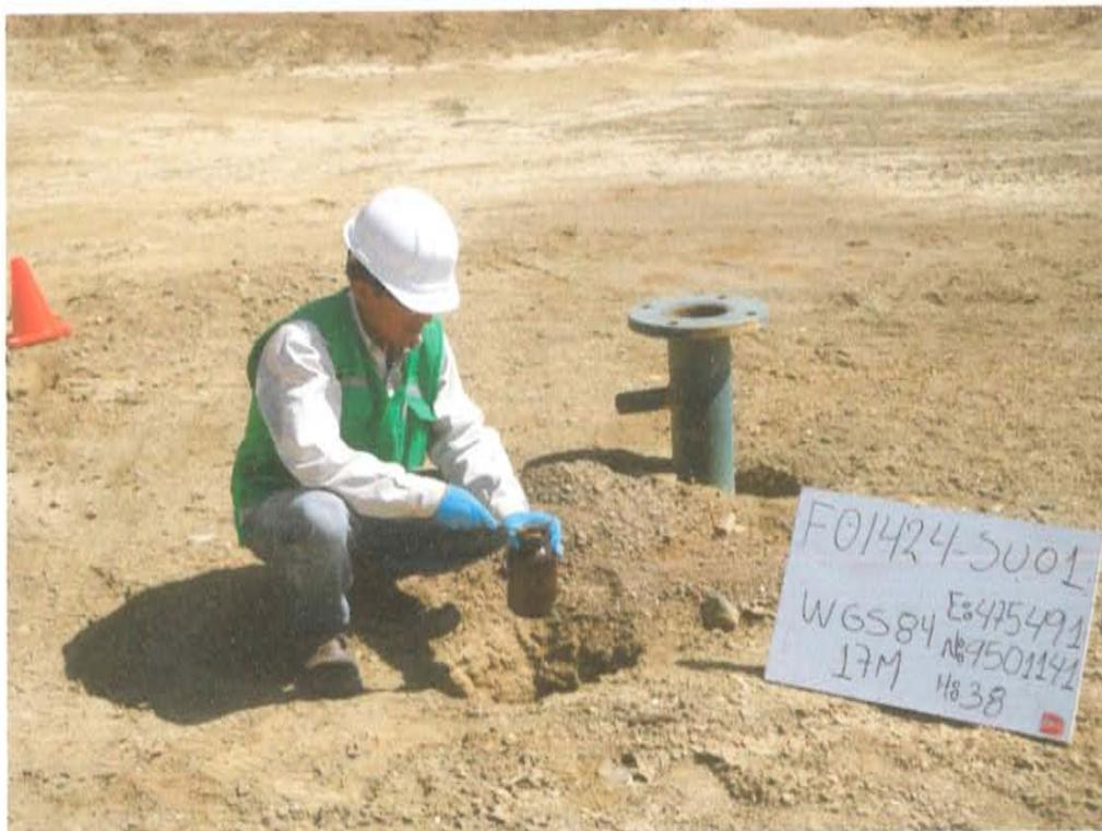
Fotografía N° 3. Toma de muestra aproximadamente a 1.5 m del pozo.
