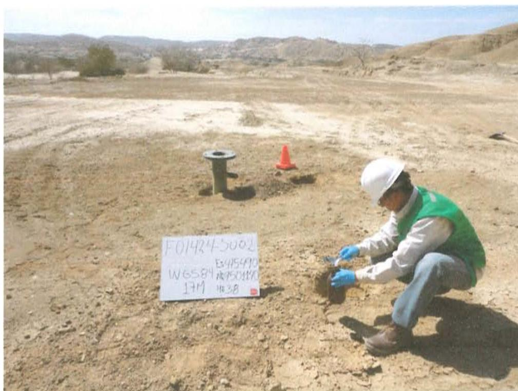
Fotografía N° 4. Toma de muestra de suelo aproximadamente a 3 m del pozo.
