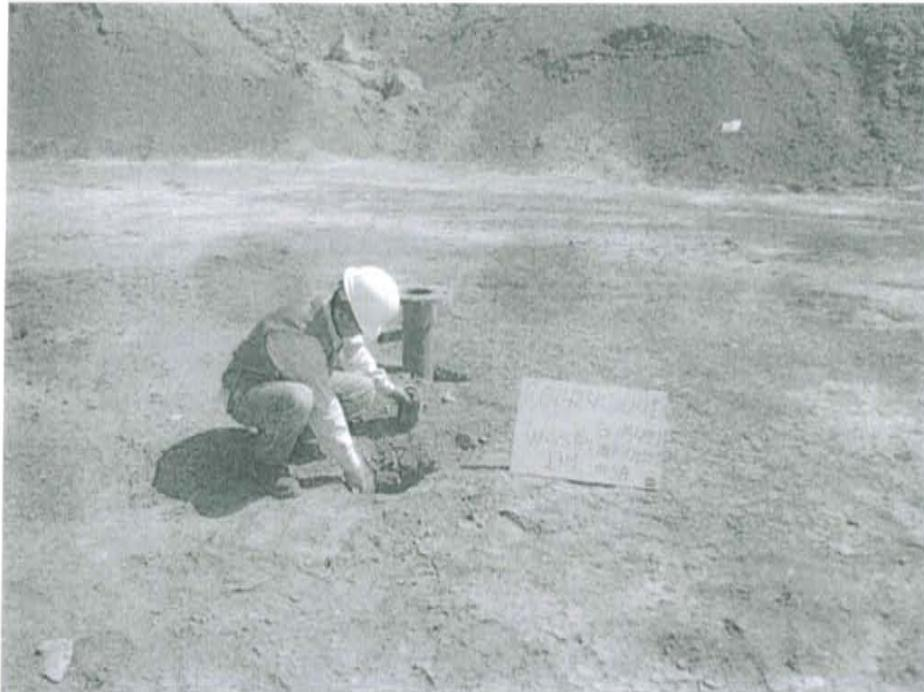
Fotografía N° 1. Toma de muestra de suelo en el punto F01424-SU01, ubicado a 1.5 m aproximadamente del Pozo T3464.
