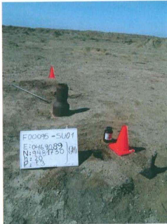
Fotografía N° 3. Toma de muestra de suelo F00095-SU1 del Pozo T\_571.
