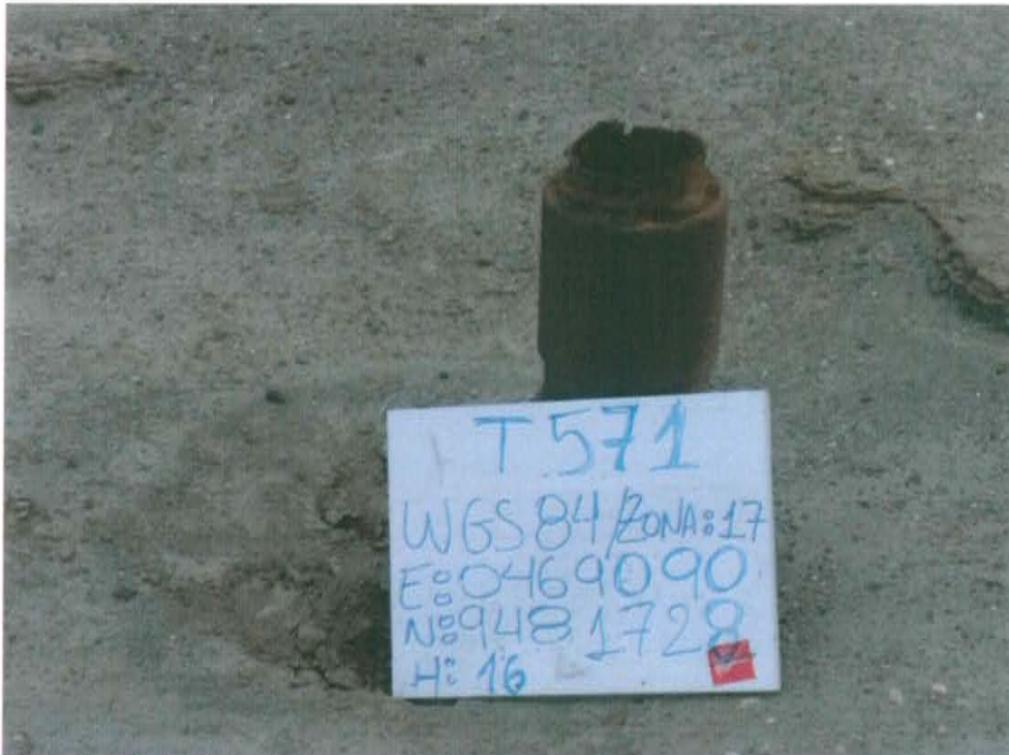
Fotografía N° 1. Vista del Pozo T\_571, presenta casing que sobresale 0,51 m sobre el nivel del suelo.
