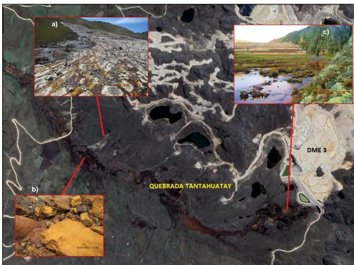
**Figura 8.7.** Evidencia de las ferricretas en la quebrada Tantahuatay. a) Ferricretas, b) Bloques y gravas alteradas con presencia de óxidos y c) Naciente de la quebrada con el depósito de material estéril 3 (DME 3). Fotografías de la vigilancia ambiental en la UM Tantahuatay 2019.
