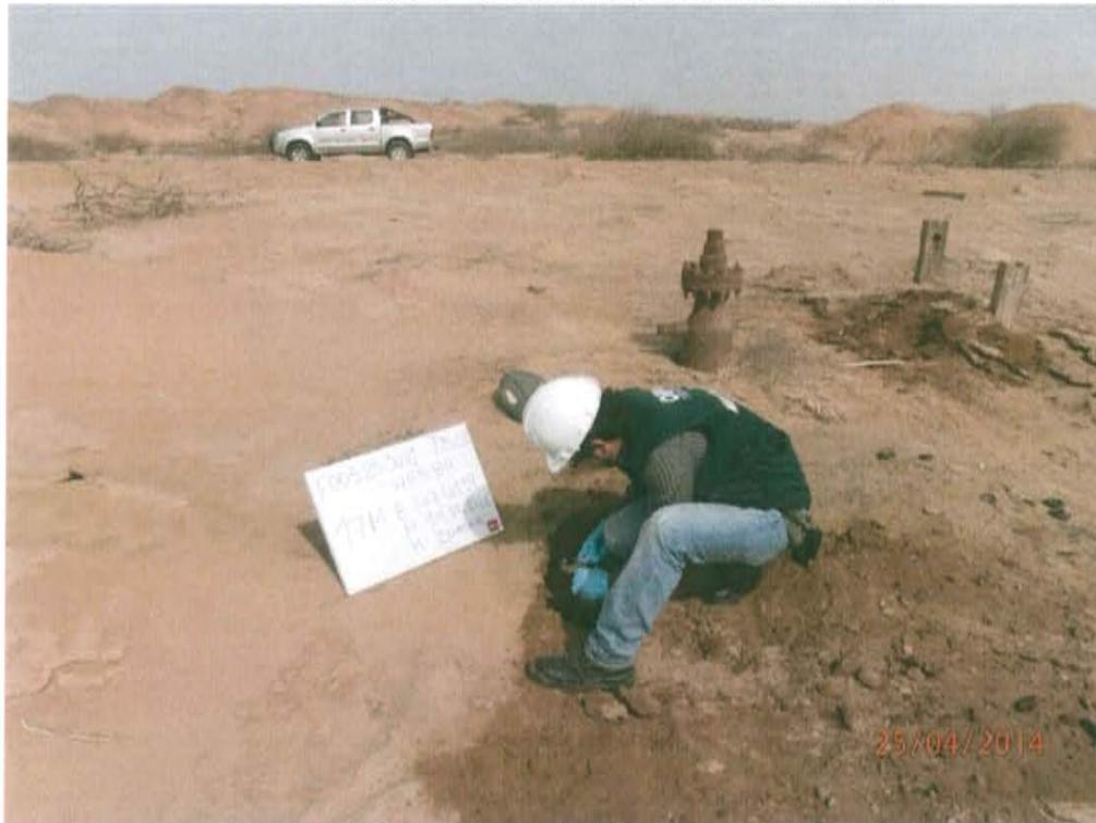
Fotografía N° 5. Toma de muestra de suelo en el punto F00525-SU01, ubicado a 2 m aproximadamente del Pozo T2501.
