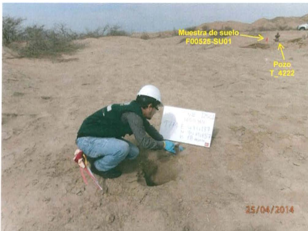
Fotografía N° 6. Toma de muestra de suelo en el punto F00525-SU02, ubicado a 25 m aproximadamente del Pozo T2501.
