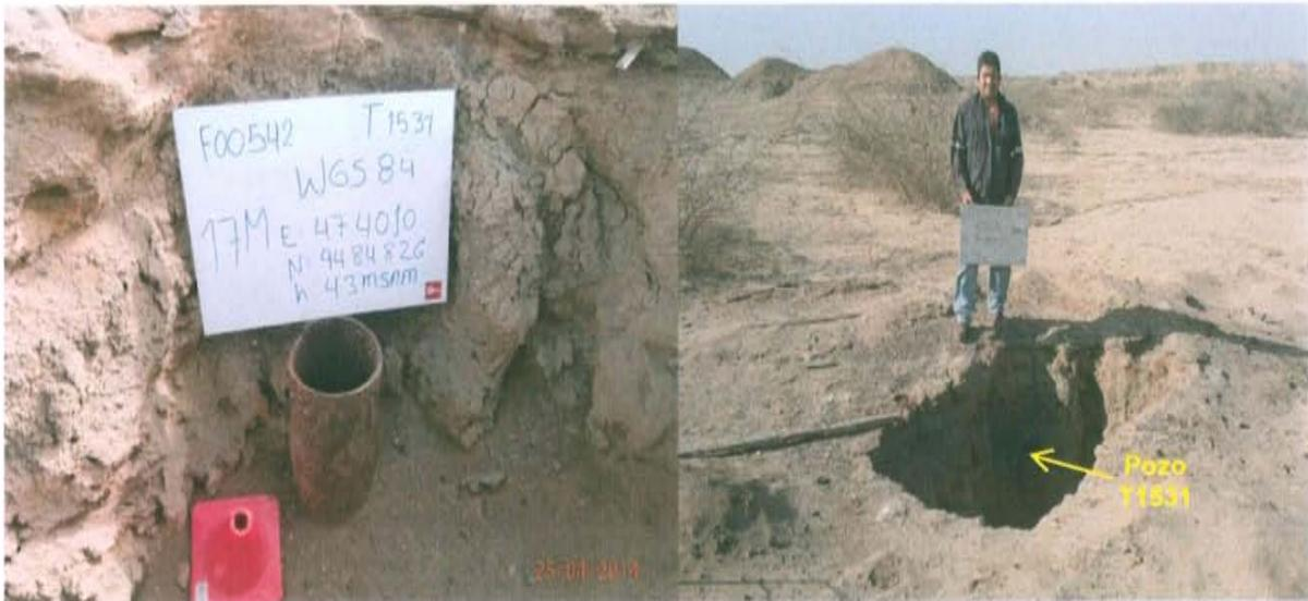
Fotografía N° 1. Pozo inactivo T1531, dentro de una excavación de sección rectangular, fuera de producción y no cuenta con elementos de cierre.
