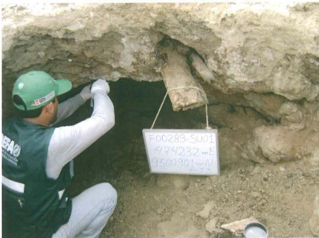
Fotografía N° 3. Toma de muestra de F00289-SU01 en zona impregnada a 3 m de distancia del pozo.
