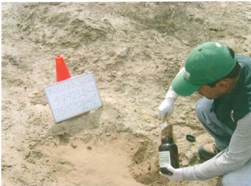
Fotografía N° 4. Toma de muestra de F00289-SU02 en zona impregnada a 2 m de distancia del pozo.
