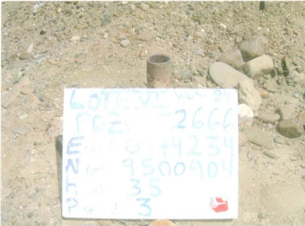
Fotografía N° 1. Identificación del pozo inactivo con código PERUPETRO T2666, se observa pozo mal abandonado sin cabezal y expuesto al aire libre.
