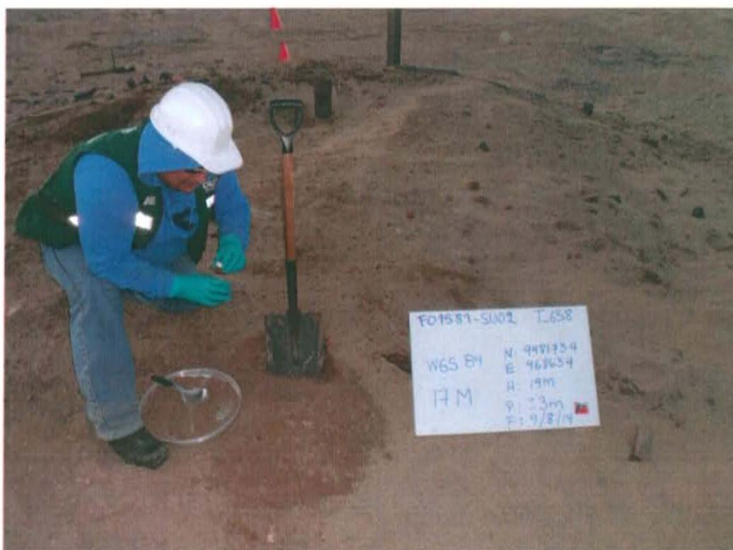
Fotografía N° 4. Toma de muestra de suelo en el punto F01581-SU02, ubicado a 4 m aproximadamente, al sur del Pozo T\_658.
