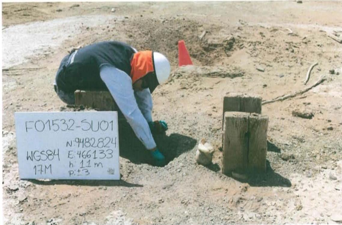
Fotografía N° 5. Toma de muestra de suelo en el punto F01532-SU01, ubicado a 1,81 m aproximadamente del Pozo T\_618.
