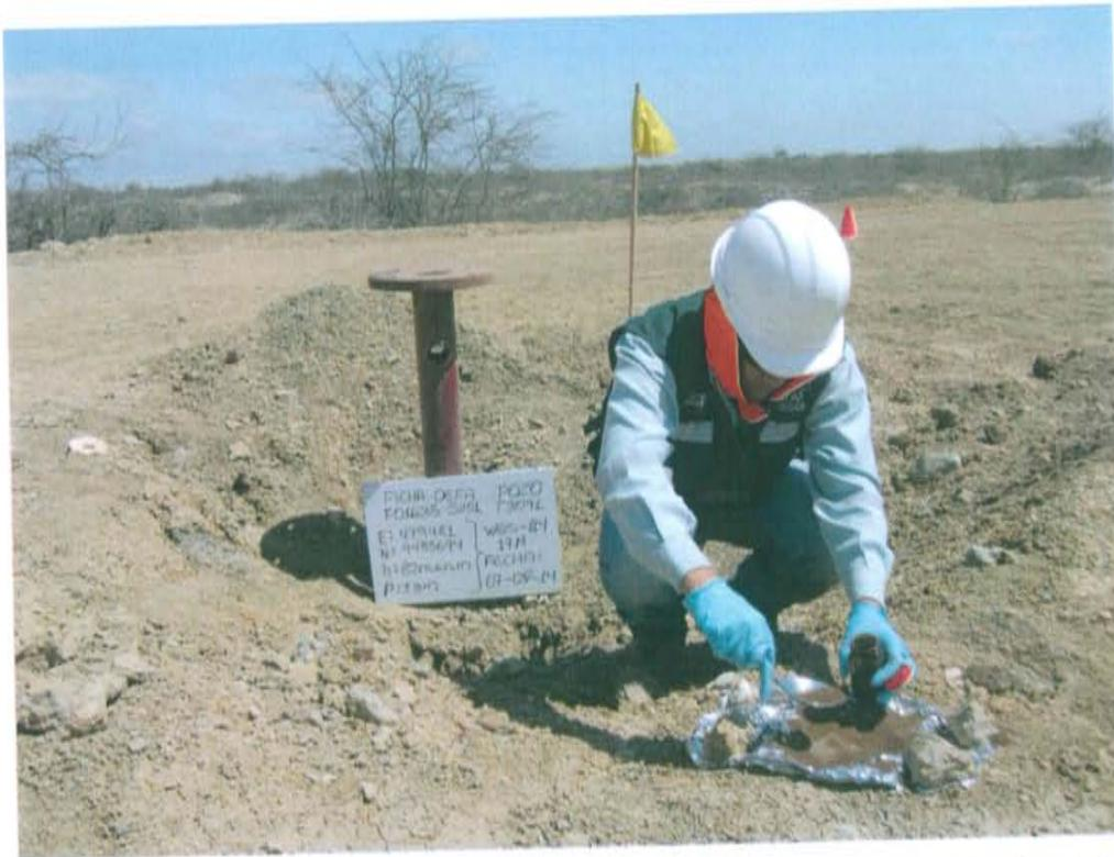
Fotografía N° 3. Toma de muestra de suelo en el punto F01635-SU01, ubicado a 0,9 m aproximadamente del Pozo T3091.
