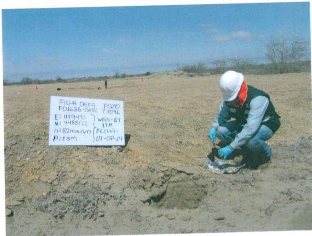
Fotografía N° 4. Toma de muestra de suelo en el punto F01635-SU02, ubicado a 16 m aproximadamente del Pozo T3091.
