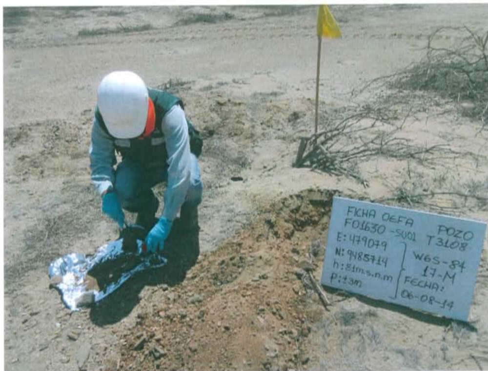
Fotografía N° 3. Toma de muestra de suelo en el punto F01630-SU01, ubicado a 1,2 m aproximadamente del Pozo T3108.
