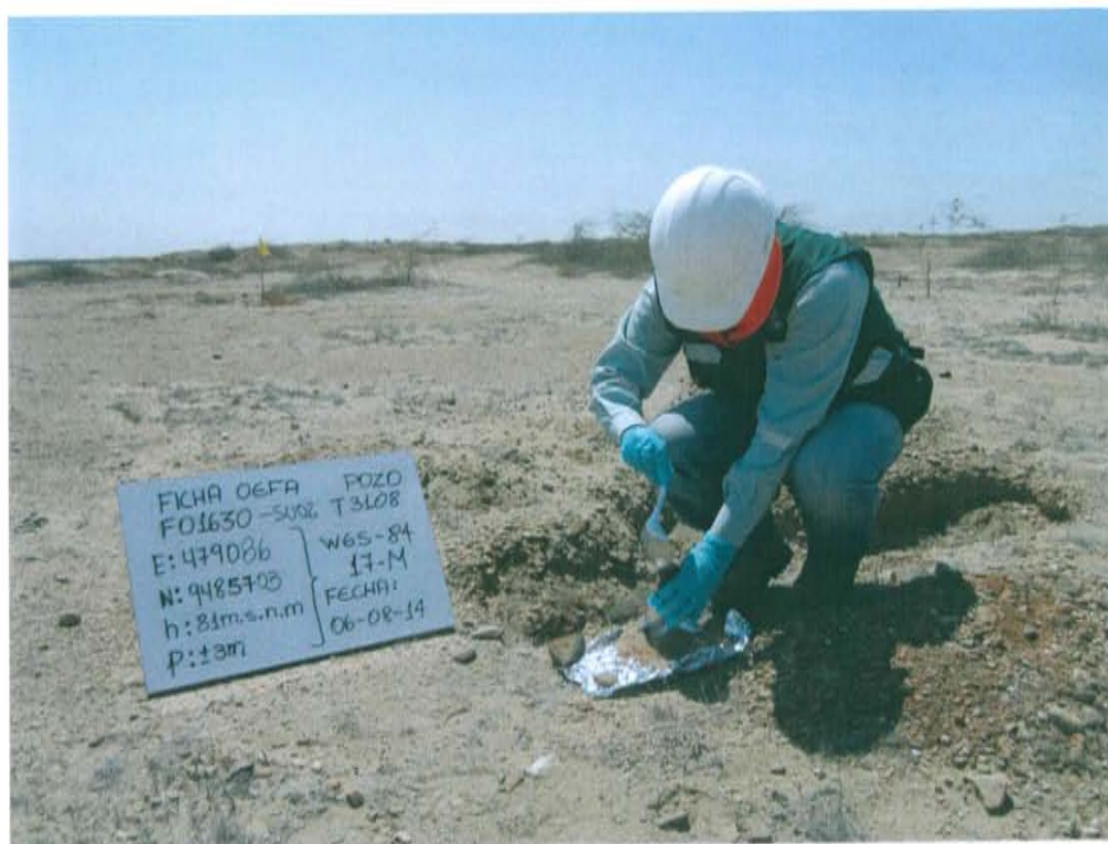
Fotografía N° 4. Toma de muestra de suelo en el punto F01630-SU02, ubicado a 10 m aproximadamente del Pozo T3108.
