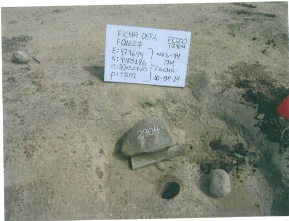
Fotografía N° 1. Pozo inactivo con código PERUPETRO T2904. Se observa casing a nivel de superficie y suelo impregnado alrededor.
