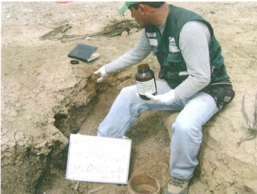
Fotografía N° 3. Toma de muestra de pozo F00293-SU01 en zona impregnada a 1 m de distancia del pozo.
