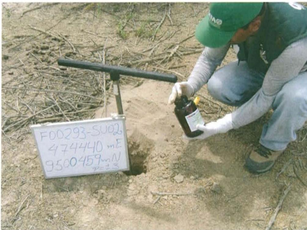
Fotografía N° 4. Toma de muestra de pozo F00293-SU02 en zona impregnada a 12 m de distancia del pozo.
