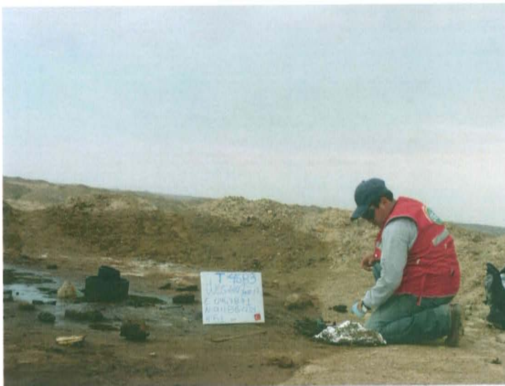
Fotografía N° 3. Toma de muestra de suelo con presencia de residuo de hidrocarburo en el pozo T4683.
