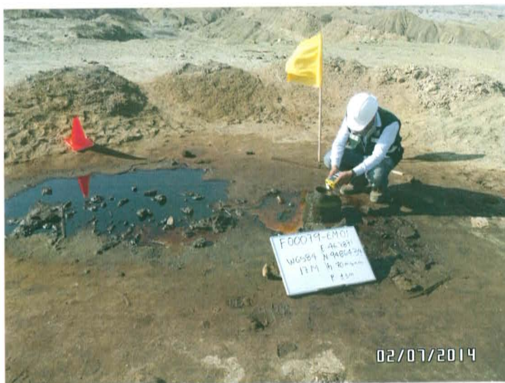
Fotografía N° 4. Medición en el punto F00079-EM01, ubicado en la fuente de emisión en boca del Pozo T4683.
