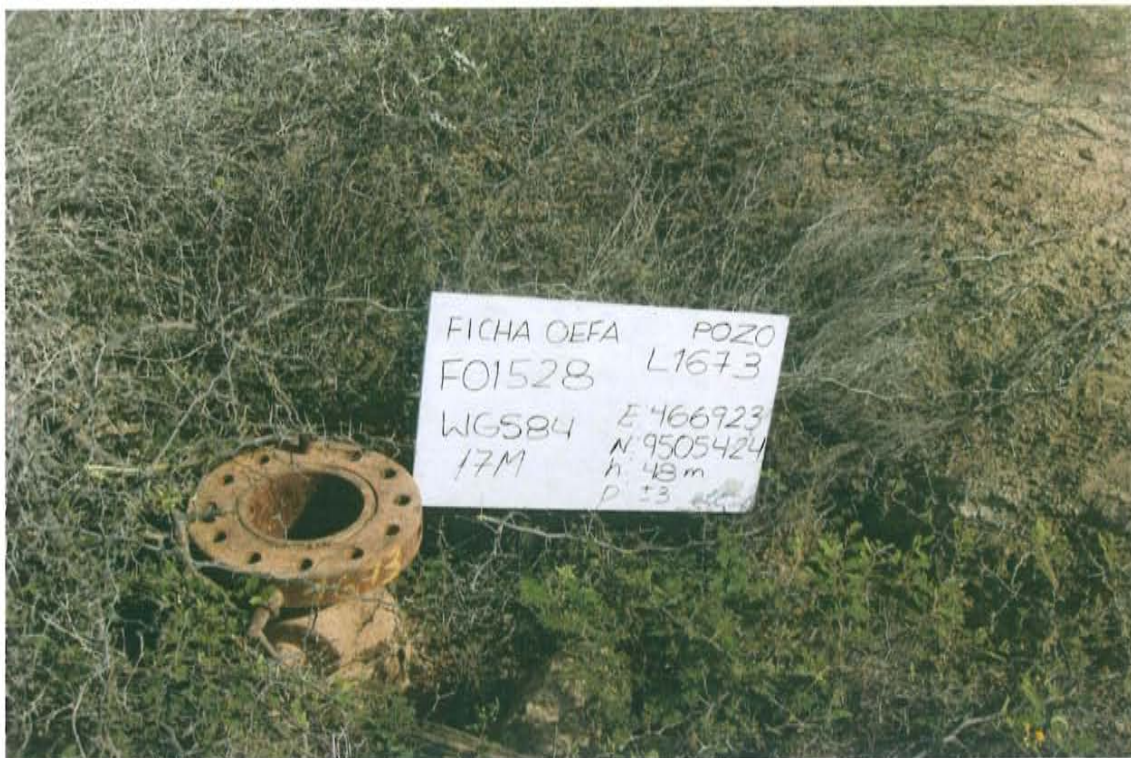
Fotografía N° 1. Identificación del pozo inactivo con código PERUPETRO L1673. Presenta casing corroído y abierto con tapa de brida en el interior de una excavación con vegetación.
