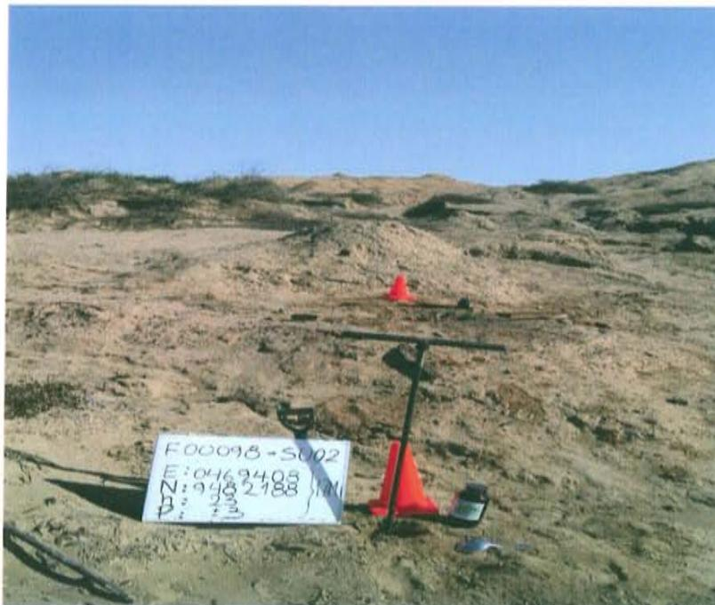
Fotografía N° 4. La muestra de suelo se tomó a 2,2 m de distancia del pozo y a una profundidad de 0,32 m de la superficie del suelo.
