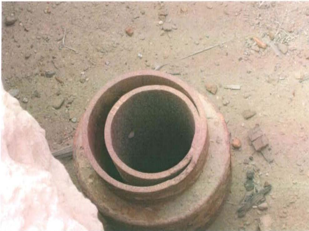
Fotografía N° 2. Se observa tres casing cortados y corroídos; sin cabezal ni válvulas que aseguren su hermetismo.
