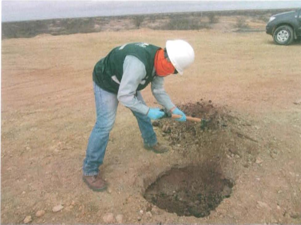
Fotografía N° 3. Se observa adyacente al pozo T1848 suelo impregnado a los 0,6 m de profundidad, el cual ha sido enterrado con el material de préstamo.
