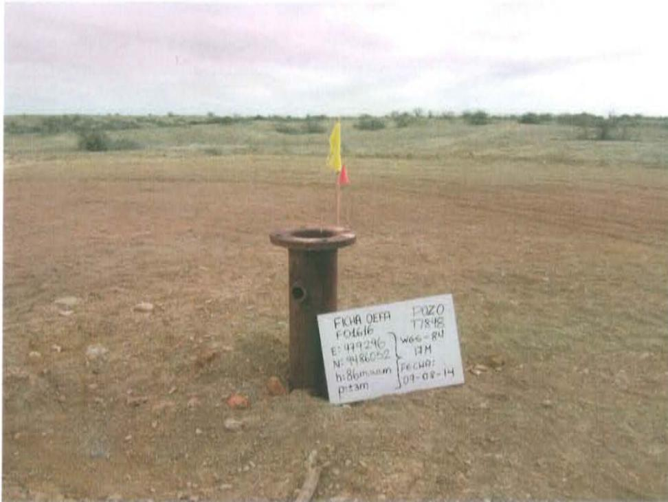
Fotografía N° 1. El Pozo T1848, presenta cabezal compuesto por una brida, unida a un casing de aproximadamente 8 pulgadas, sin válvulas que aseguren su hermetismo.
