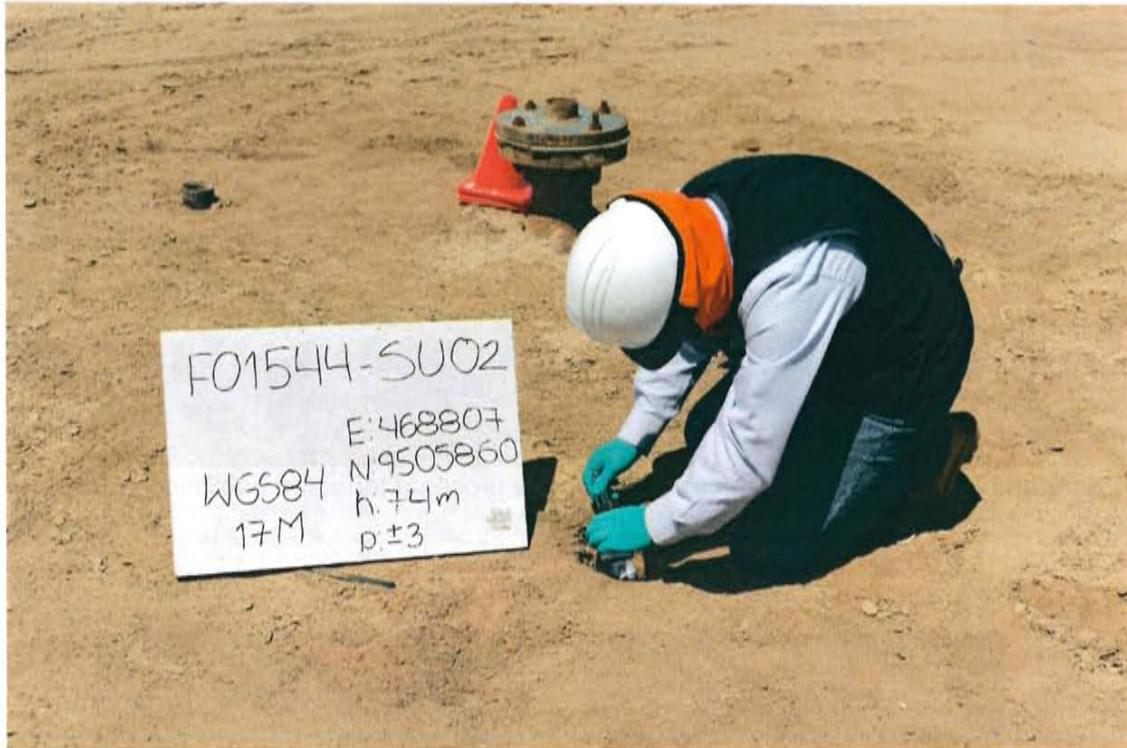
Fotografía N° 3. Toma de muestra de suelo en el punto F01544-SU02, ubicado a 1,8 m aproximadamente del Pozo L\_530.
