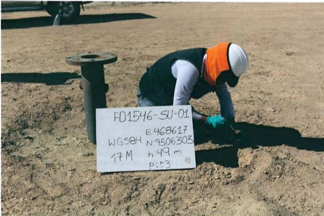
Fotografía N° 3. Toma de muestra de suelo en el punto F01546-SU01, ubicado a 0,93 m aproximadamente del Pozo L\_385.
