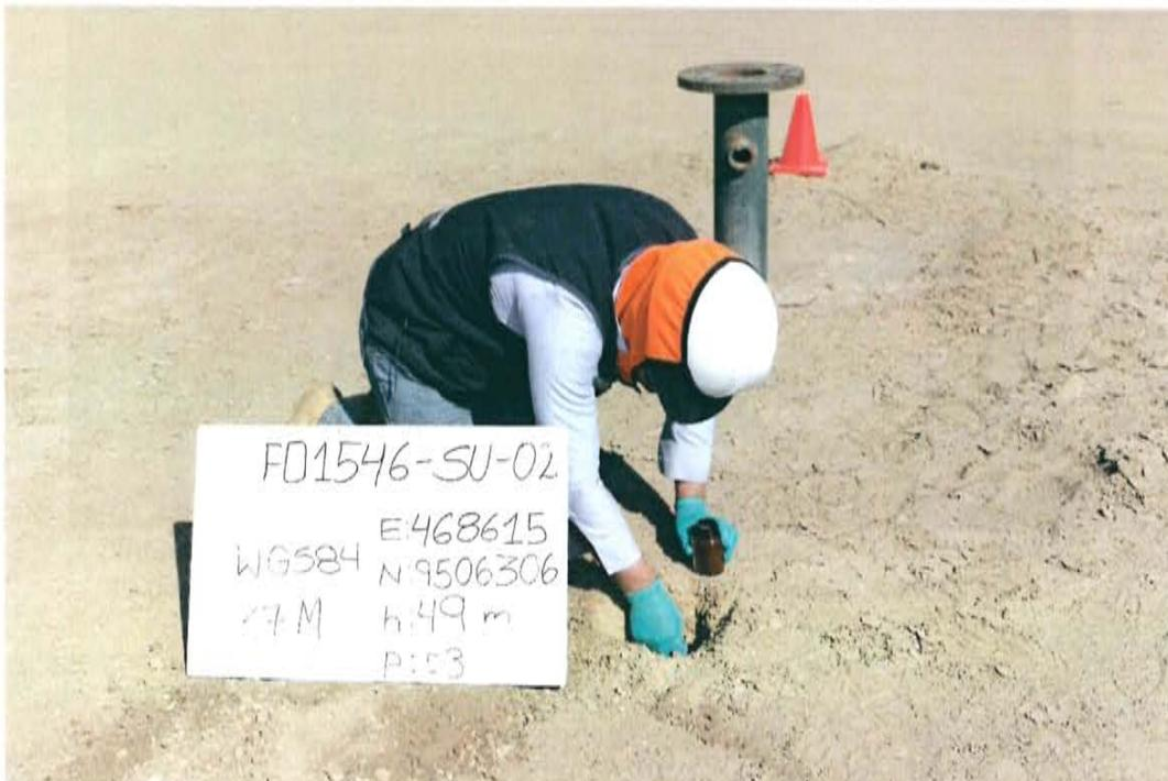
Fotografía N° 4. Toma de muestra de suelo en el punto F01546-SU02, ubicado a 2,12 m aproximadamente del Pozo L\_385.
