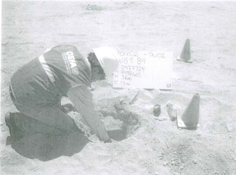
Fotografía N° 1. Toma de muestra de suelo en el punto F01702-SU01 ubicado a 0,4 m al sur del Pozo T3180
