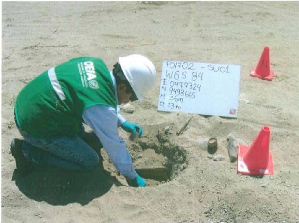
Fotografía N° 3. Toma de muestra de suelo en el punto F01702-SU01 ubicado a 0,4 m al sur del Pozo T3180.
