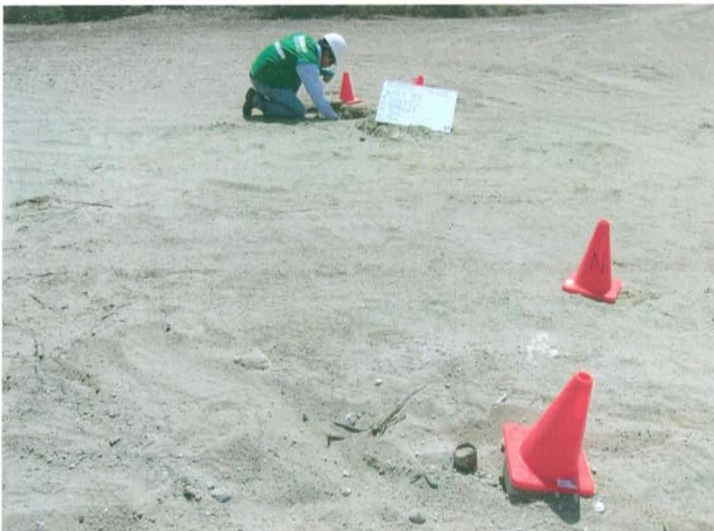
Fotografía N° 4. Toma de muestra de suelo en el punto F01702-SU02 ubicado a 5,5 m al noroeste del Pozo T3180.
