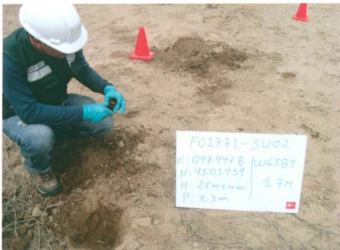
Fotografía N° 04.- Toma de muestra de suelo en el punto F01771-SU02, ubicado a 3,8 m aproximadamente del pozo T3601.
