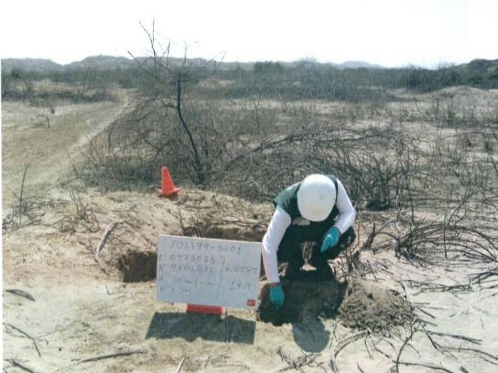
Fotografía N° 1. Toma de muestra de suelo en el punto F01799-SU01, ubicado a 1,5 m aproximadamente del Pozo T3326.
