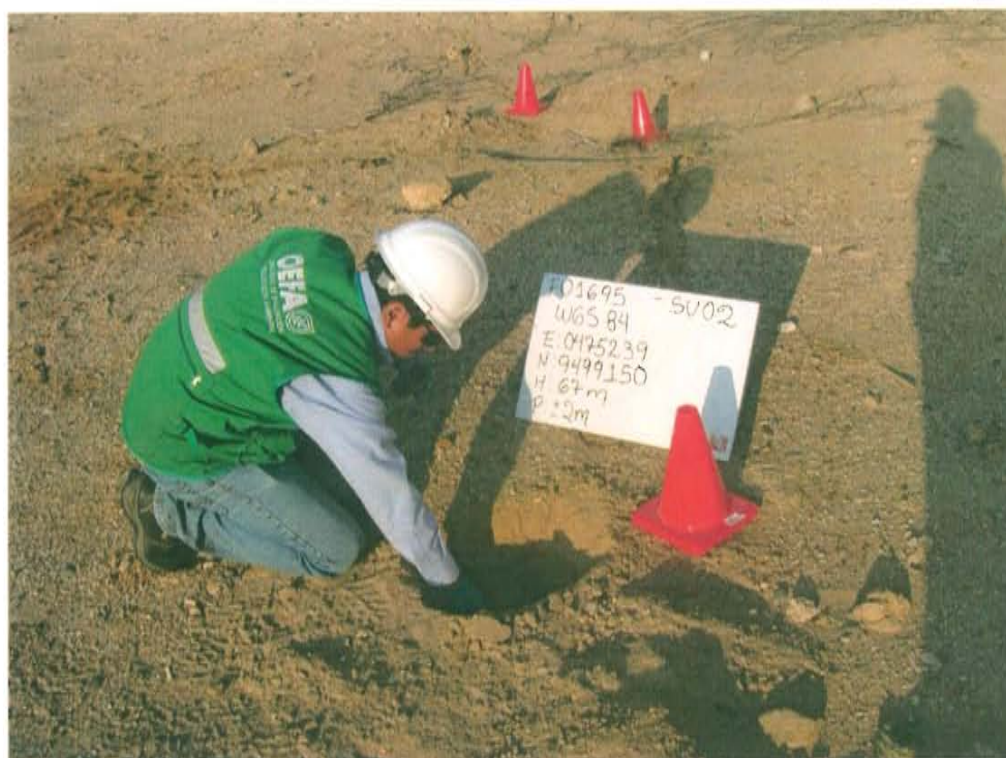
Fotografía N° 4. Toma de muestra de suelo en el punto F01695-SU02 ubicado a 3 m al suroeste del Pozo T3238.
