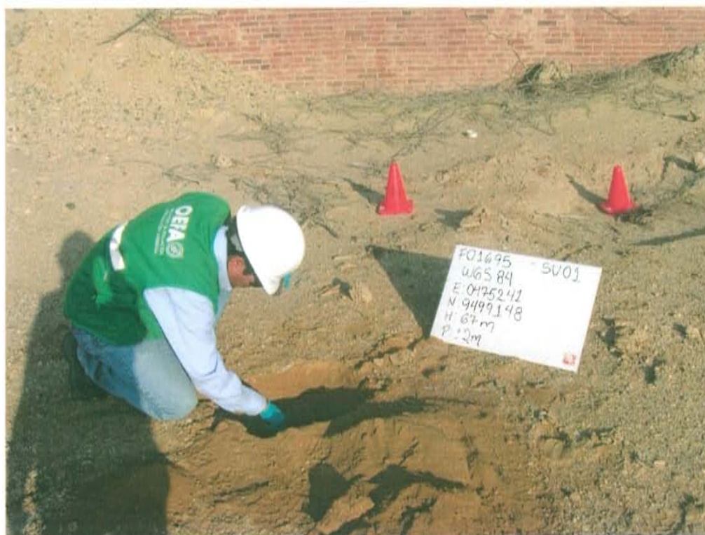
Fotografía N° 3. Toma de muestra de suelo en el punto F01695-SU01 ubicado a 1,5 m al noroeste del Pozo T3238.
