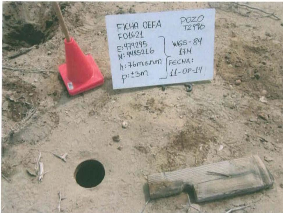
Fotografía N° 1. El Pozo T2996 presenta casing al ras del suelo de aproximadamente 6,5 pulgadas, sin cabezal ni válvulas que aseguren su hermetismo.
