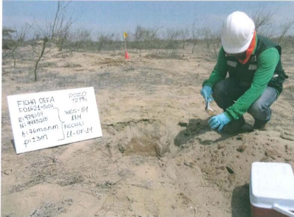
Fotografía N° 4. Toma de muestra de suelo en el punto F01621-SU02, ubicado a 12 m del Pozo T2996.
