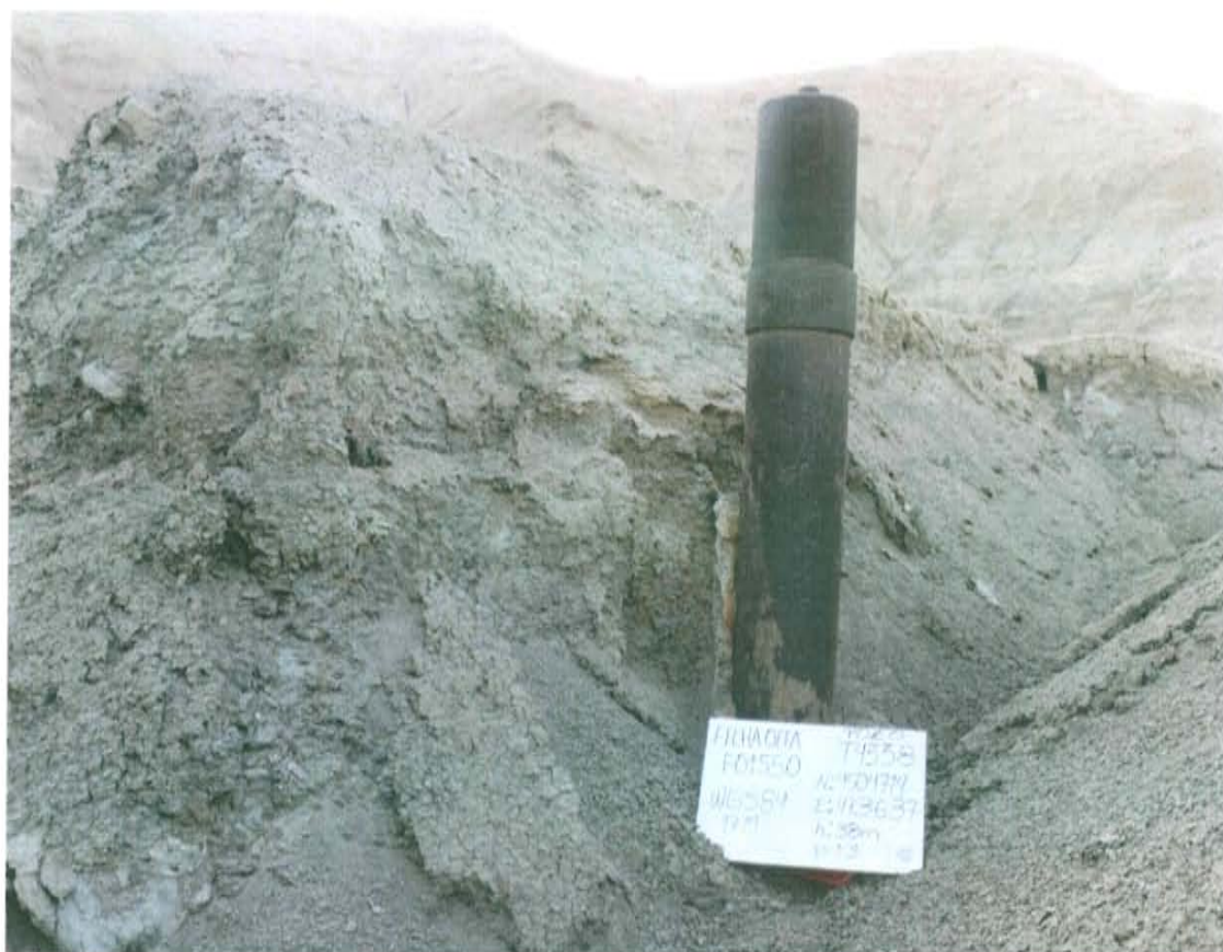
Fotografía N° 2. Se puede apreciar el casing corroído, con tapa de hierro.
