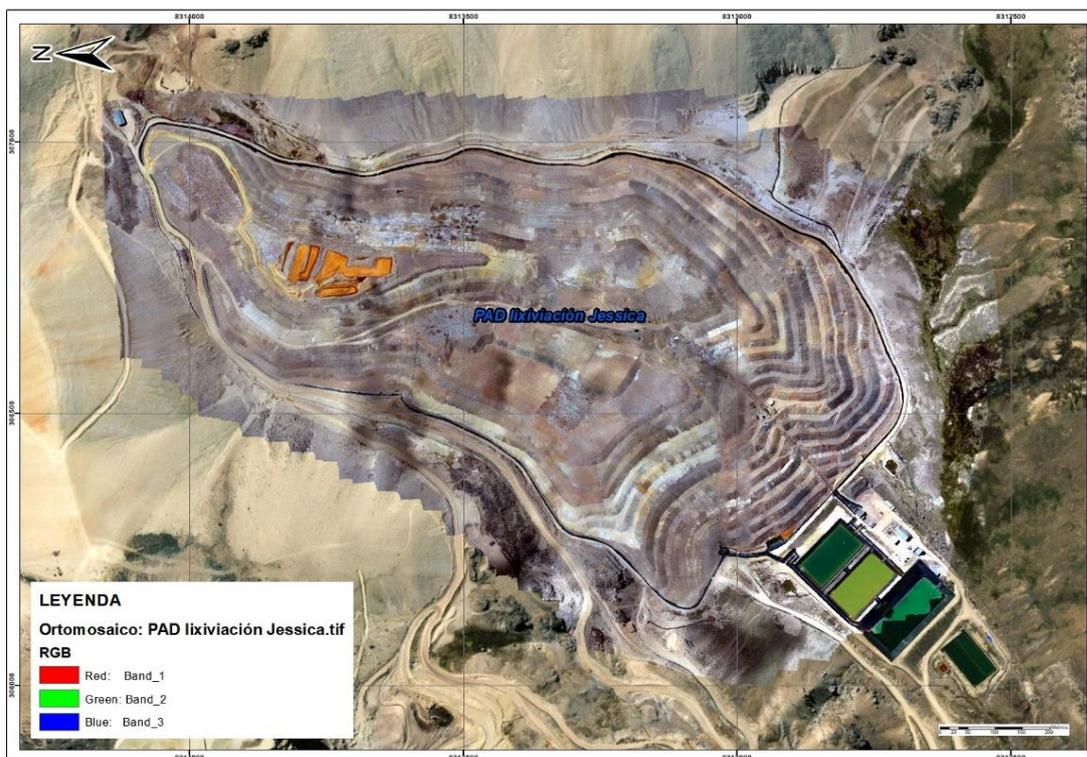
Figura 6.3. Ortomosaico RGB del PAD de lixiviación Jessica de la UF Arasi.
