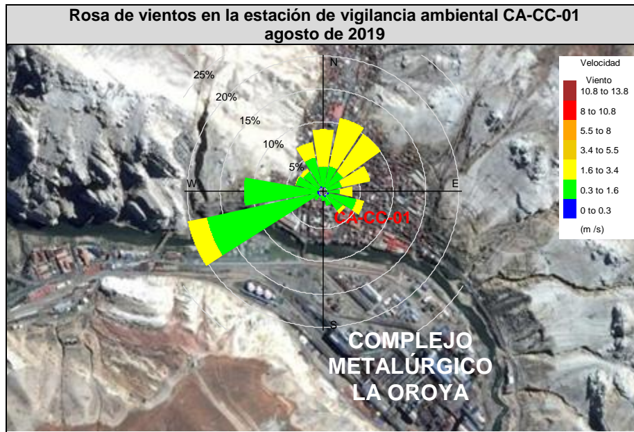
Figura 5.2. Ubicación de la estación de vigilancia ambiental CA-CC-01 y rosa de vientos en agosto de 2019.
