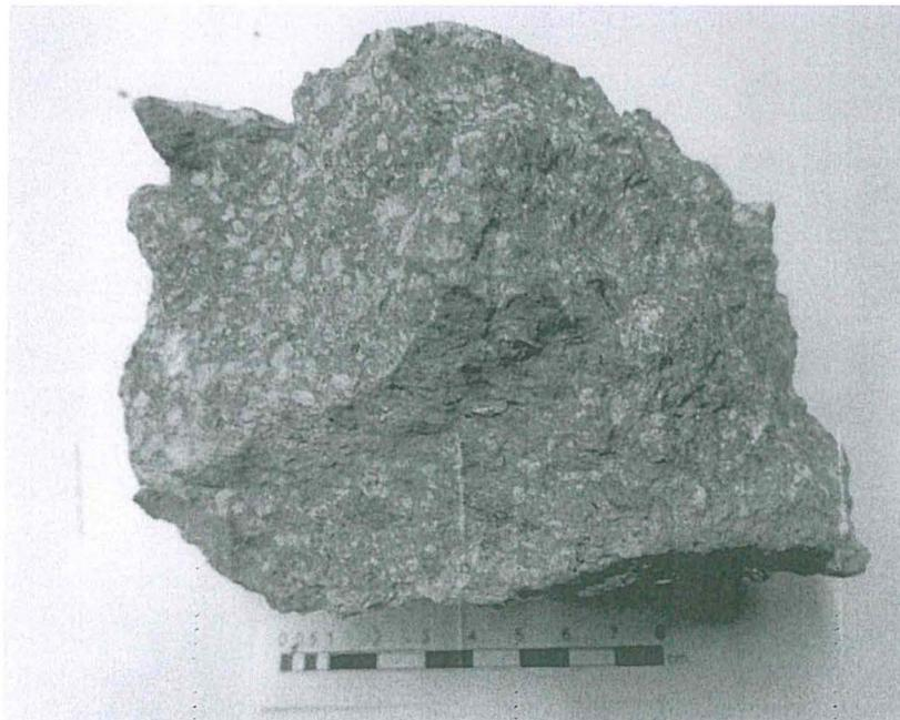
Fotografía 10. Muestra de roca de la cabecera de la quebrada Millojauira, de composición andesítica fuertemente oxidada y con presencia de sulfuros de hierro
