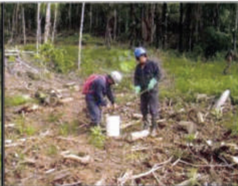
Foto 08: Realizando calicatas para la colecta de la muestra M01.
