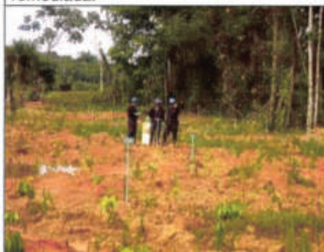
Foto 09: Realizando monitoreo de suelos y haciendo la colección de las muestras de las calicatas realizadas para la muestra M-01.
