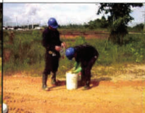
Foto 10: Realizando el mezclado, homogenizado y cuarteado de la muestra M-01.
