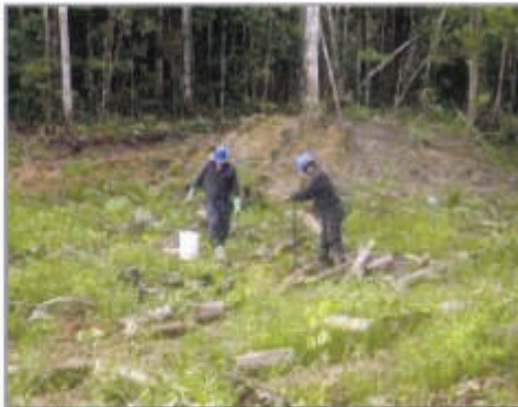
Foto 07: Realizando monitoreo de suelos, colecta de muestra M-01, personal de GyM realizando las calicatas respectivas.
