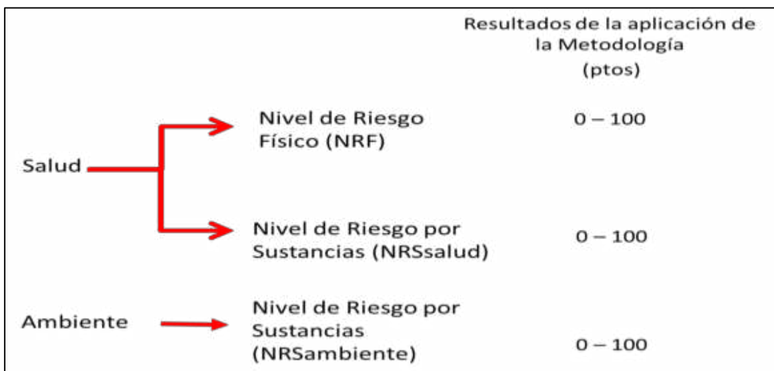
Figura 7.4. Indicadores de riesgos por presencia de peligros de tipo físico y por presencia de sustancias contaminantes.
