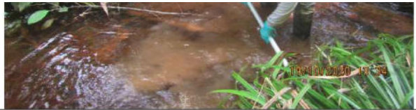
Muestreo de macrobentos con red D-net en el punto S388-HB-002 en la quebrada.
