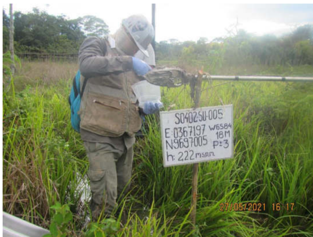
Punto de muestreo de suelo S0402-SU-005 en el sitio S0402, en el que se registró excedencias de los ECA Suelo de uso agrícola para fracciones de hidrocarburos F2 y F3.
