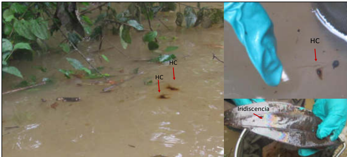
Figura 8.16. Películas oleosas e iridiscencia en el punto S0402-HB-005
