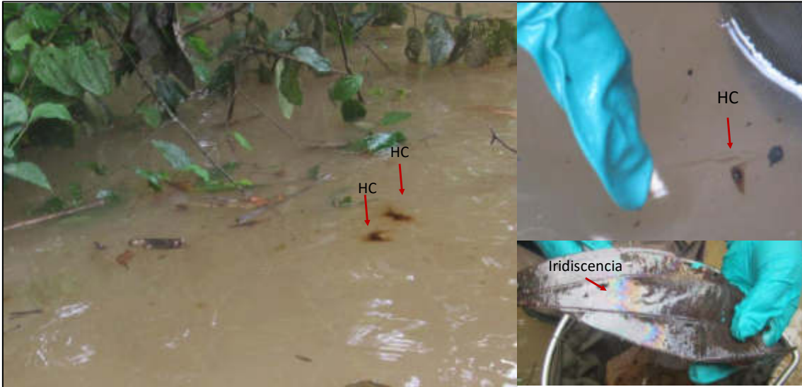
Figura 4.4. Películas oleosas y negras similares a hidrocarburos (HC) en el punto S0402-HB-005 e iridiscencia observada en las hojarasca del fondo del cuerpo de agua.
