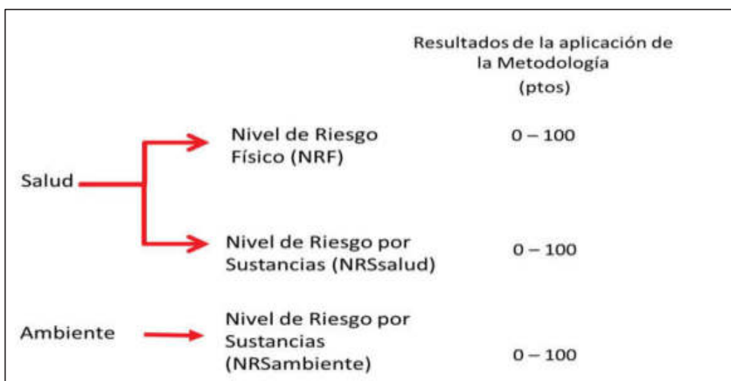
Figura 7.1. Indicadores de riesgos por presencia de peligros de tipo físico y por presencia de sustancias contaminantes.
