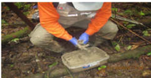
homogenización de muestra duplicado durante el muestreo de suelo en el sitio S0375
