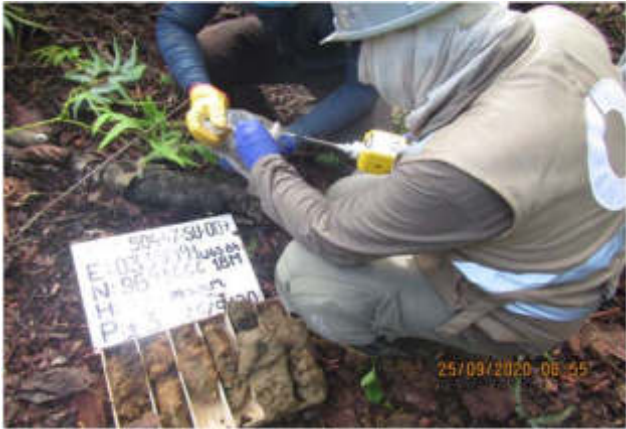
Evaluación de perfil de suelo y medición de PID para la toma de muestra de suelo.
