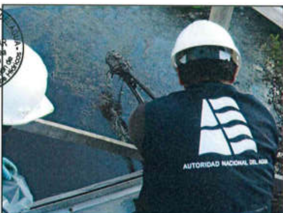
Foto N° 28: Laguna PAC 5 con sedimentos de Hidrocarburos Totales de Petróleo (HTP) de 14 480 mg/Kg.
