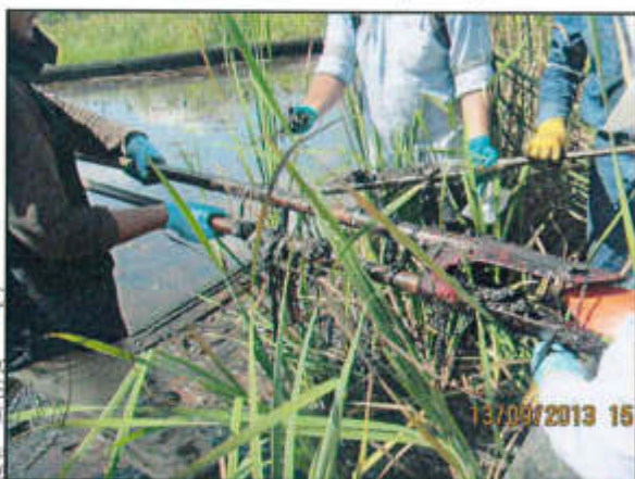
Foto N° 26: Laguna PAC 1-3 (1) con sedimentos en el fondo de Hidrocarburos Totales de Petróleo (HTP) de 6 362 mg/Kg.
