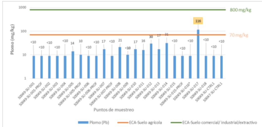
Figura 8.6. Resultados de plomo (Pb) para el sitio S0049
