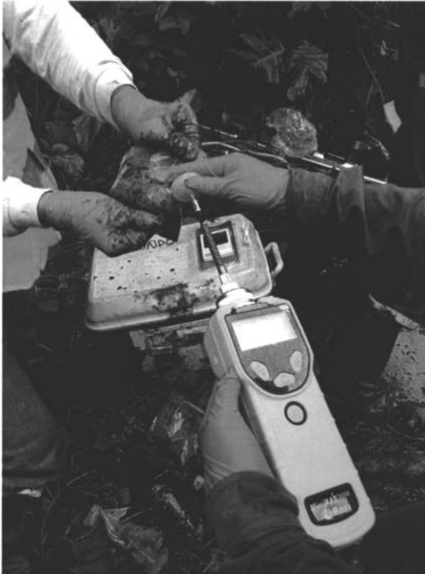
Fotografía 8. Lectura de VOC's de la muestra del sondeo 011, mediante el PID.
