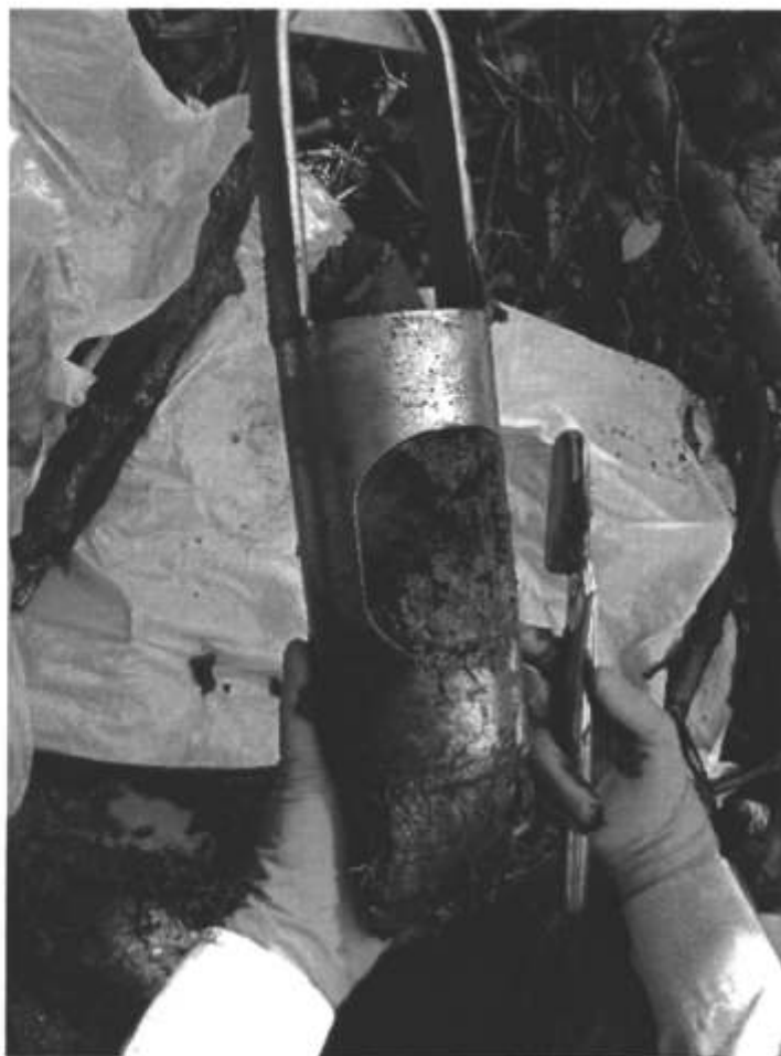
Fotografía 10. Muestra de suelo con afectación de hidrocarburos.
