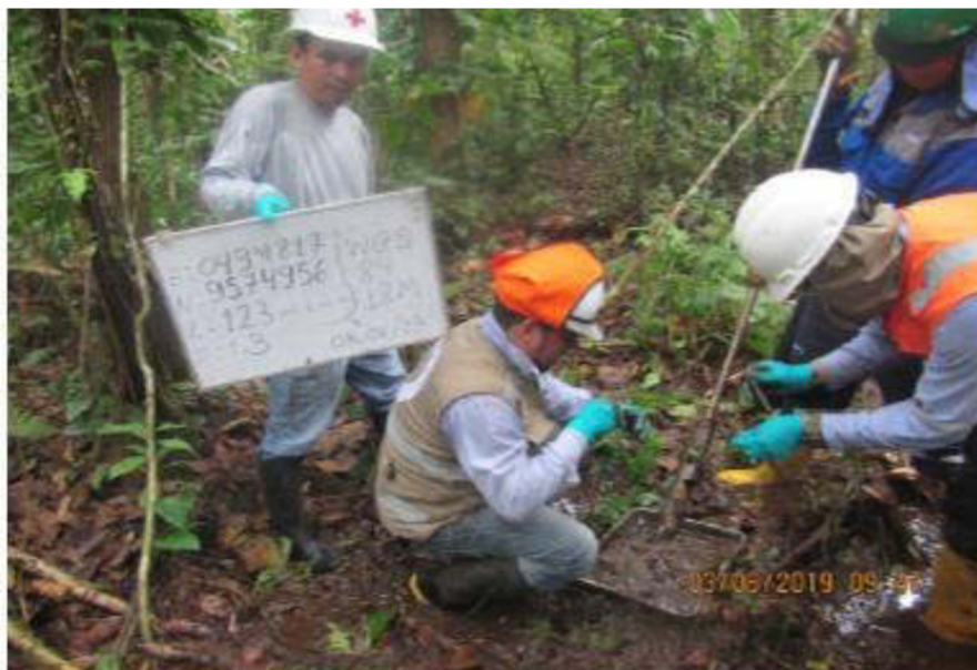
Punto de muestreo de suelo con código S0046-SU-003, en el cual se evidencia la saturación del suelo, color marrón. El suelo presenta de textura arcillosa.
