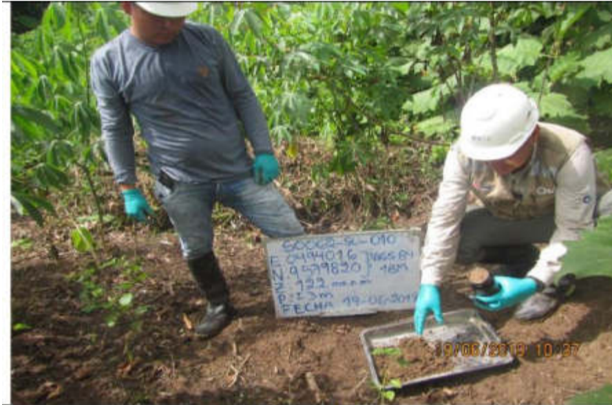
Muestreo de suelo en el punto S0062-SU-010 de los parámetros TPH F2 (C 10 -C 28 ), TPH F3 (C 28 -C 40 ) y PAHs luego de su homogenización en una bandeja de aluminio. Se observa abundante vegetación herbácea, con presencia de suelo húmedo y arcilloso.
