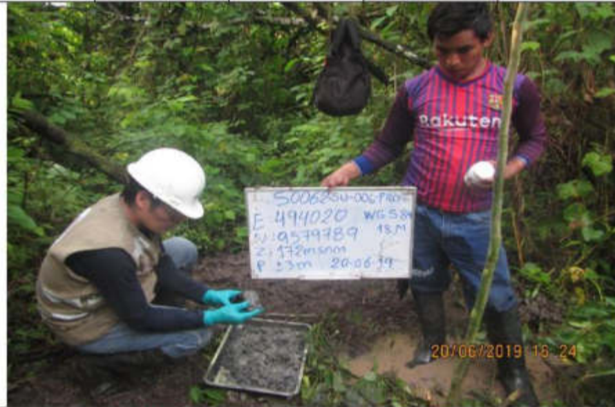
Muestreo de suelo en el punto S0062-SU-006-PROF de los parámetros TPH F2 (C 10 -C 28 ), TPH F3 (C 28 -C 40 ) y PAHs luego de su homogenización en una bandeja de aluminio. Se observa vegetación herbácea y arbórea, con presencia de suelo húmedo y arcillo arenoso.
