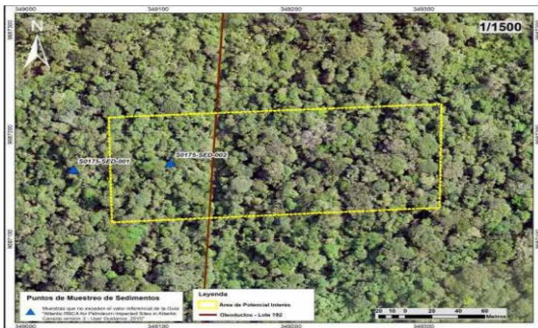
Figura 8.3. Puntos de muestreo con concentraciones que no superan la norma referencial de Canadá para Hidrocarburos Totales de Petróleo (C<sub>10</sub>-C<sub>40</sub>)
