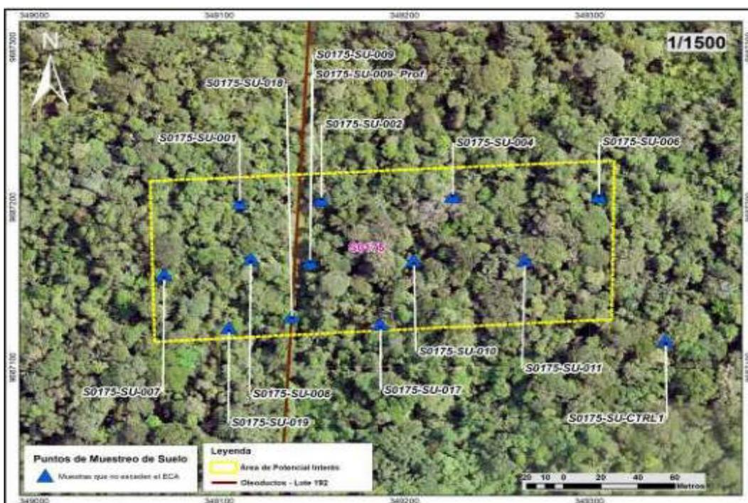
Figura 8.1. Puntos de muestreo con concentraciones que no superan el ECA para suelo de uso agrícola
